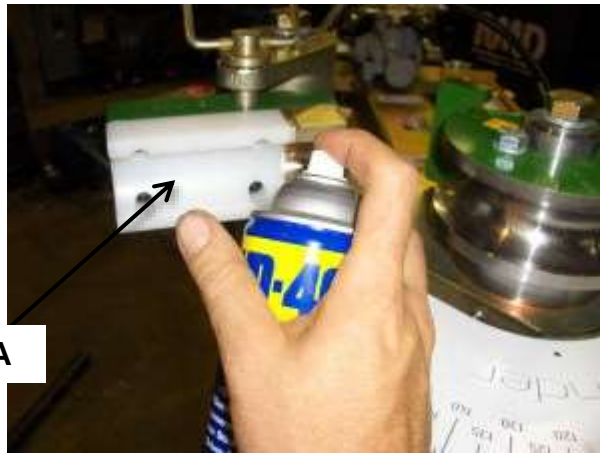
Lubricating counter die bending
