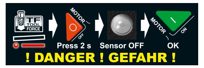
Je nach Ausführung Ihrer Kernbohrmaschine besteht die Möglichkeit, den Sensor und dessen Schutzfunktionen, einschließlich des automatischen MOTOR NOT AUS, kurzzeitig zu deaktivieren.
